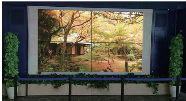
8Kマルチビジョン構築 60インチ4Kディスプレイを4面使用した120インチ映像表示システム
